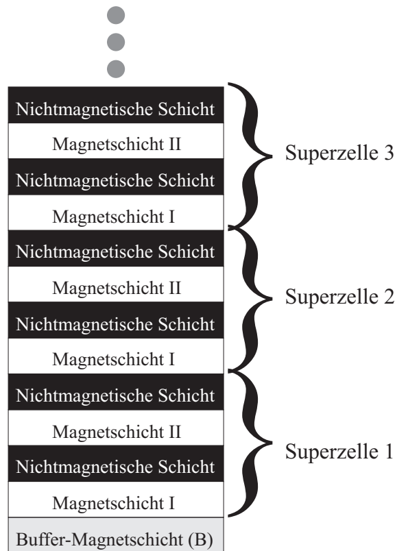
Abbildung 2.10: Aufbau eines Multilayers. Um parallele und antiparallele Magnetisierung korrekt beschreiben zu können, muss für die magnetische (im Gegensatz zur kristallographischen) Beschreibung eine Superzelle zwei ferromagnetische Schichten umfassen.
